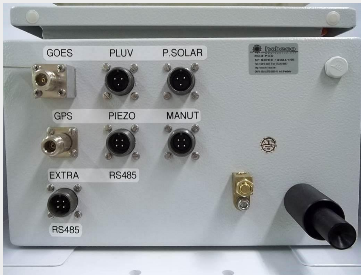
Painel inferior de conexões da PCD - Versão Sensor de Pressão
