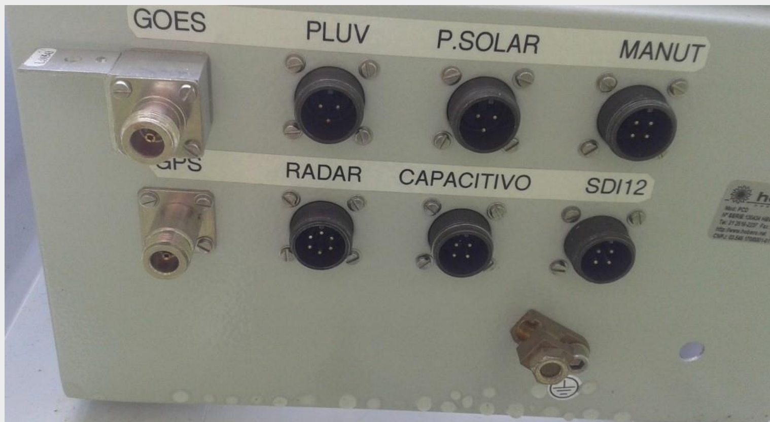
Painel inferior de conexões da PCD - Versão Radar - GOES
