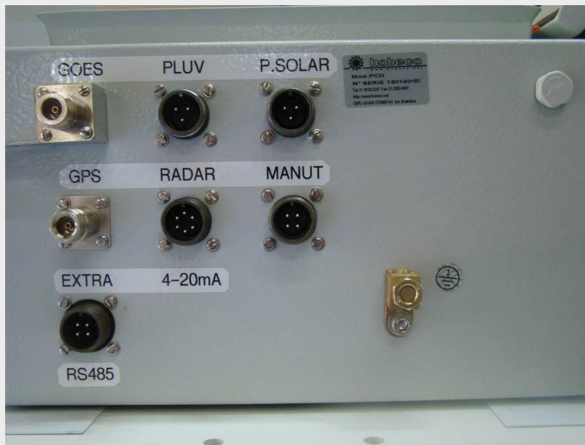
Painel inferior de conexões da PCD - Versão Radar
