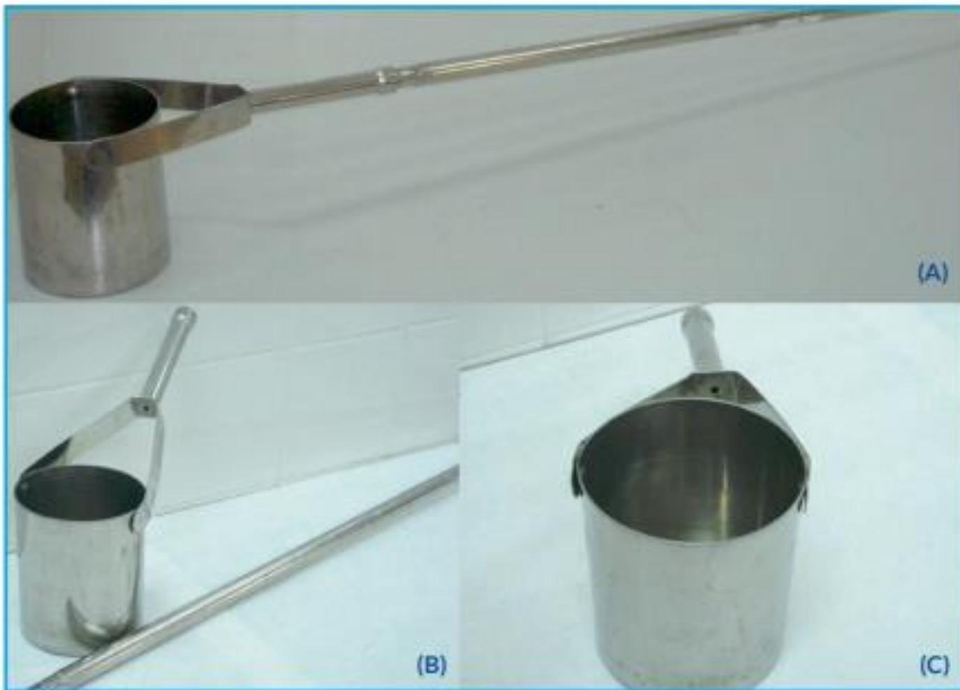
**Figura 10.** Coletor com braço retrátil: (A) Vista lateral do equipamento montado; (B) Vista do balde e do braço retrátil desmontado; (C) Vista superior do balde coletor (Fotos: Carlos Jesus Brandão/CETESB).
