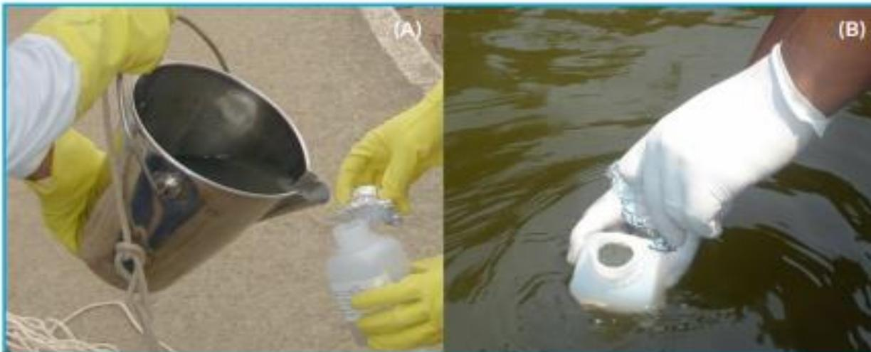
**Figura 65.** Coleta de amostra de água superficial para análise microbiológica: (A) com balde de aço inox; (B) diretamente do corpo d'água (Foto: Carlos Jesus Brandão/CETESB).
