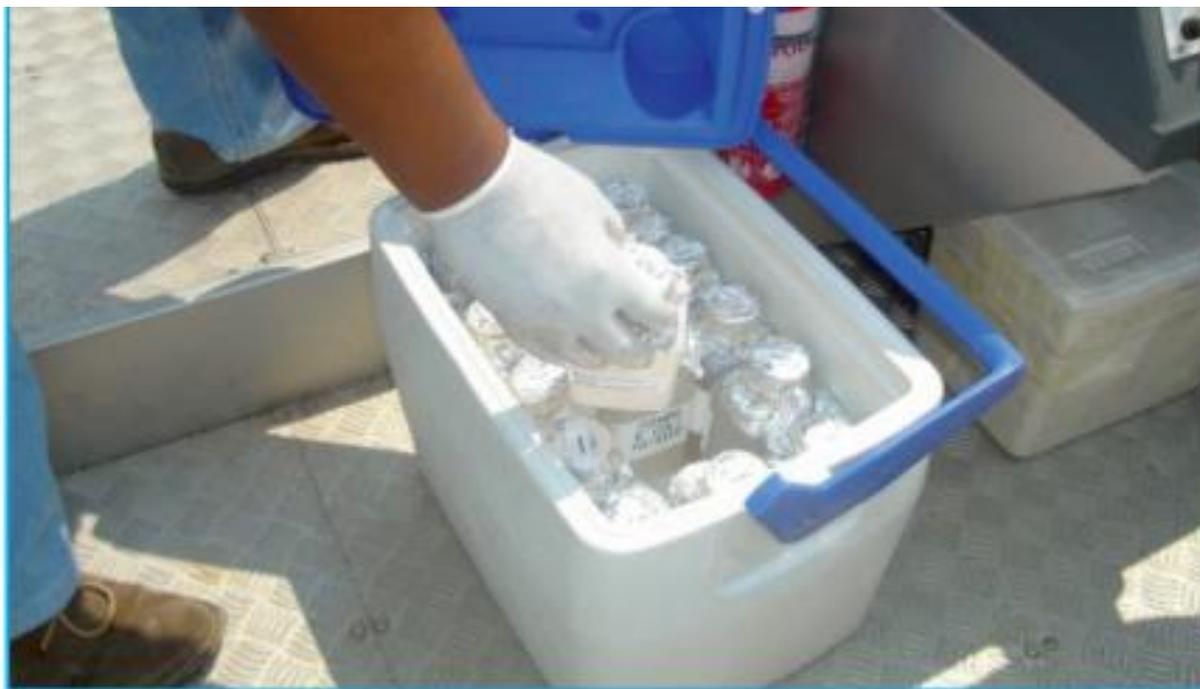
**Figura 66.** Acondicionamento e transporte de amostras para análises microbiológicas em caixa térmica sob refrigeração (Foto: Carlos Jesus Brandão/CETESB).
