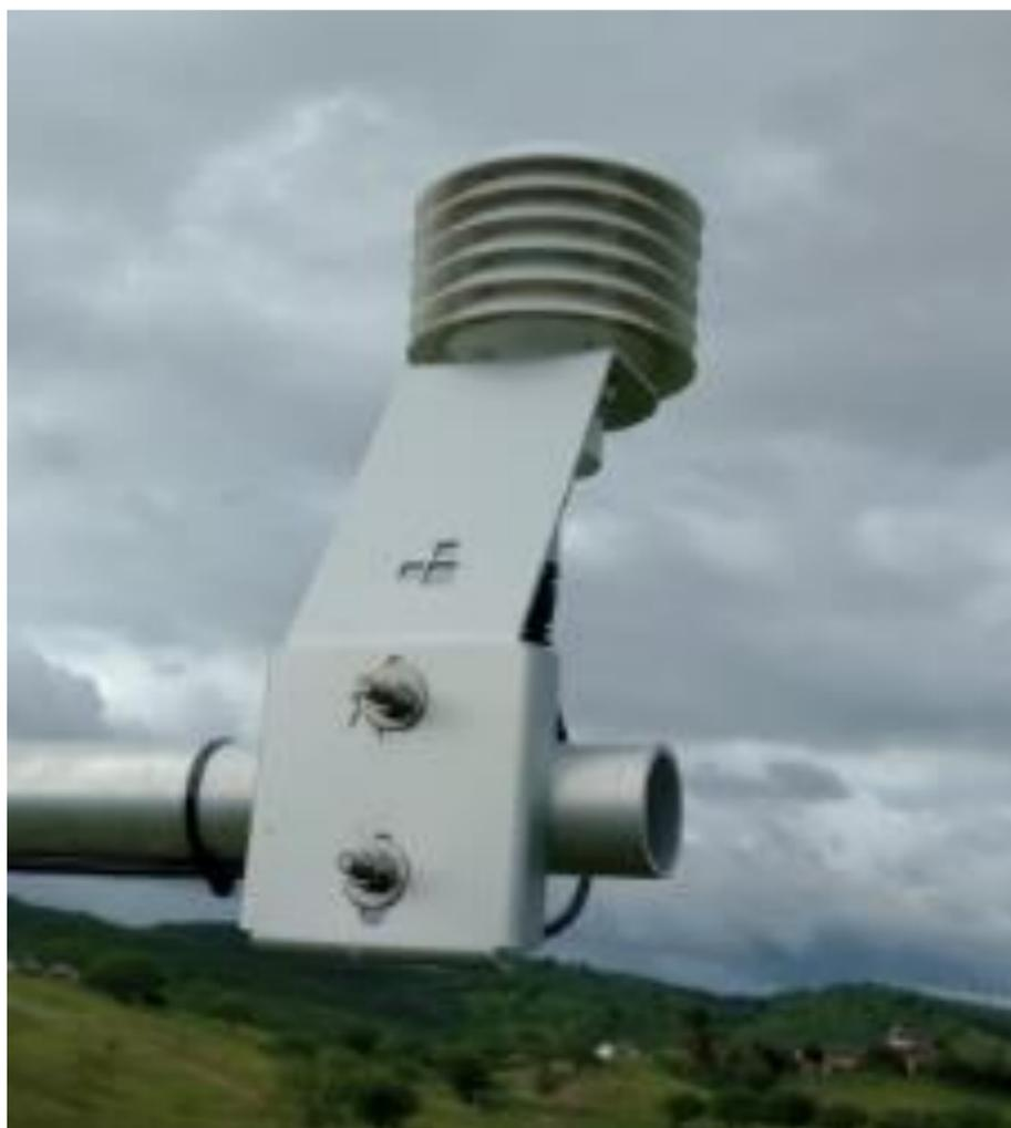
Sensor de temperatura e umidade do ar
